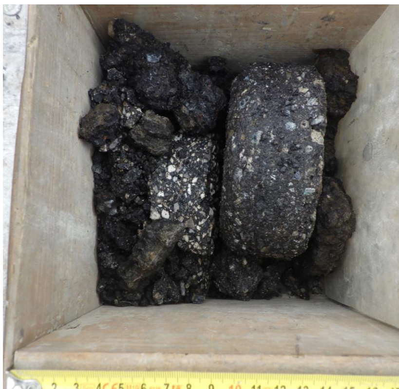
Detail asfaltových vrstev HS 1-1
