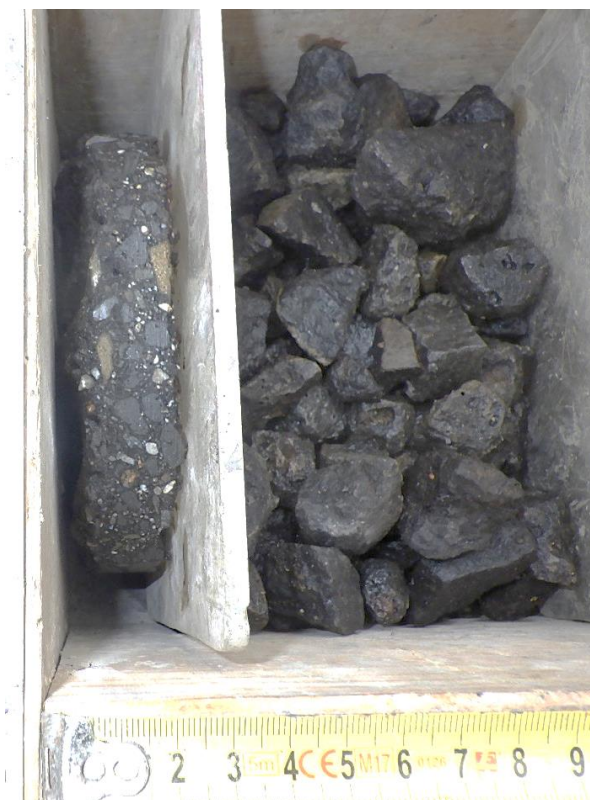
Detail asfaltových vrstev HS 4-1 a vrstvy hrubozrnného drceného kameniva HS 4-2
