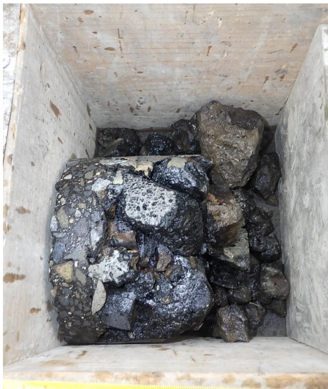
Detail asfaltových vrstev HS 5-1 a vrstvy penetračního makadamu HS 5-2
