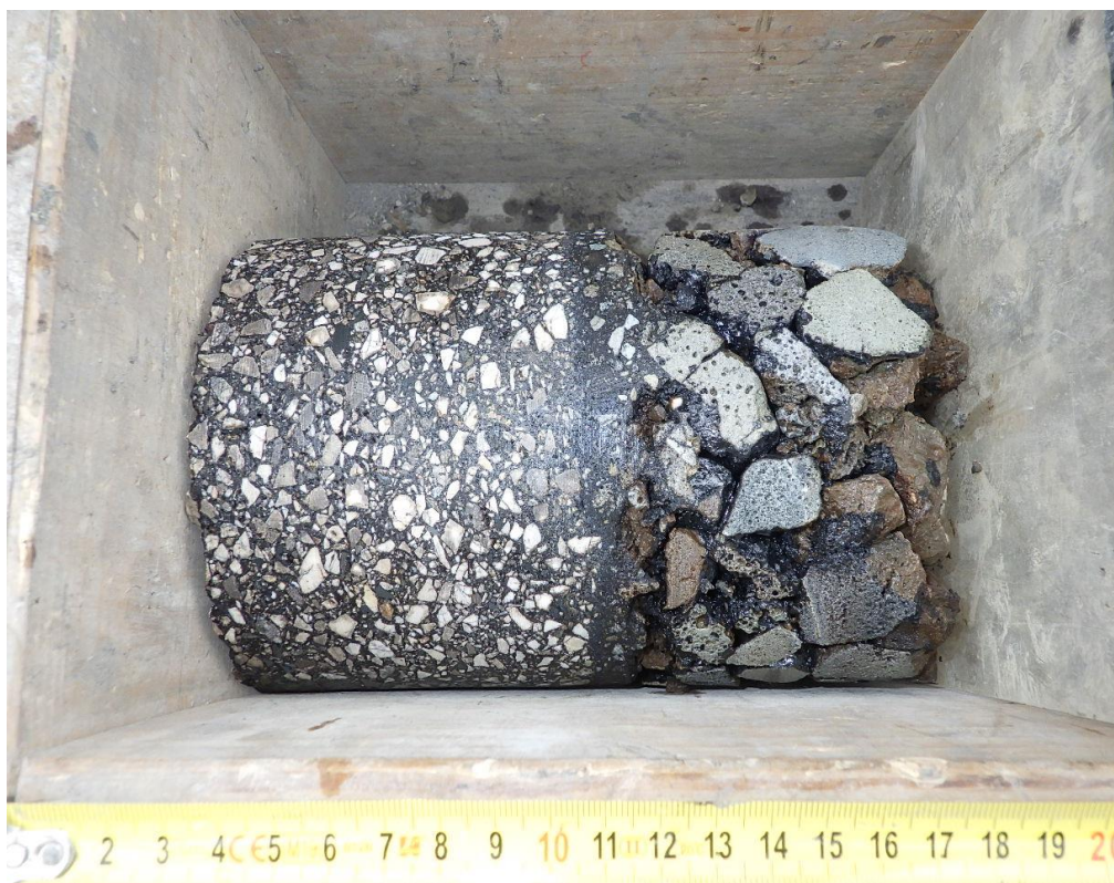
Detail asfaltových vrstev HS 3-1 a vrstvy penetračního makadamu HS 3-2
