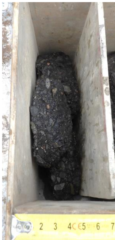
Detail asfaltových vrstev HS 2-1
